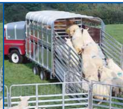
Chargement de l'étage supérieur.
