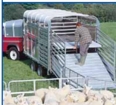
Pont EasyLoad™ déployé et barrière arrière baissée.
