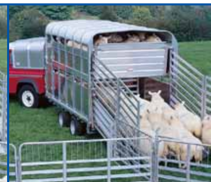
Le pont EasyLoad™ a été abaissé pour charger l'étage inférieur.
